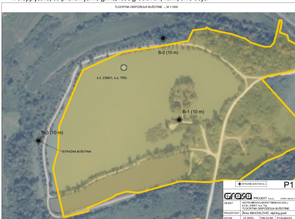
Slika 13. Položaji istražnih bušotina tijekom geotehničkih istražnih radova (Izvor: Geotehnički elaborat, 2023.)
