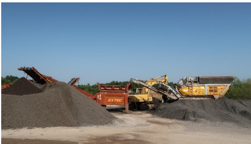
Slika 1./5. Separacija kamenog agregata
